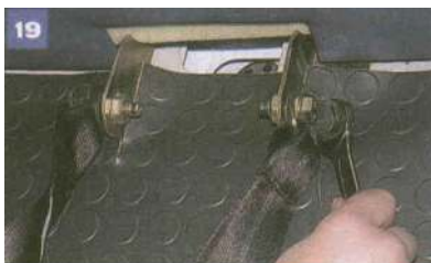
Kluczem zwykłym lub nasadowym 17 odkręcamy śrubę ...
