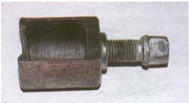
Ściągacz przegubów drążków kierowniczych.
