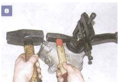
Naprężmiennie dociągając śrubę ściągnąć i uderzając w ramię poprzez podstawkę, ściągamy ramię z wielowypustu wału ...
