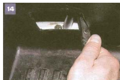
We wnęce otwartego luku, kluczem nasadowym 12 odkręcamy śrubę mocującą prowadnicę dolną.
