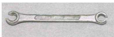
Klucz do odpowietrzania hamulców: 10; 12.
