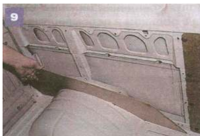
Wyciągając 12 kołków (patrz „Zdejmowanie obicia drzwi przesuwnych”) zdejmujemy płytę obicia nad nadkołem tylnego prawego koła.
