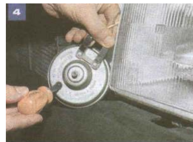
Kluczem 13 odkręcamy nakrętkę mocowania sygnału dźwiękowego do wspornika.
