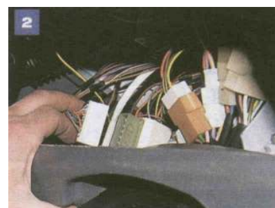
Odlączamy wtyczkę od elektrycznego korektora reflektorów.
