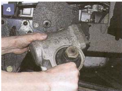
Zdejmujemy mechanizm kierowniczy.
