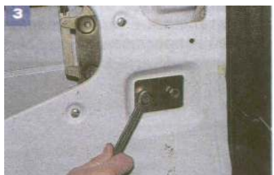
Kluczem 14 luzujemy dwie śruby mocowania mechanizmu otwierania drzwi prowadnicy środkowej ...
