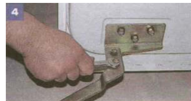
Kluczem 12 luzujemy dwie śruby mocowania dolnej dźwigni z rolką i przemieszczając dźwignię w obrębie nacięcia, regulujemy położenie dolnej krawędzi drzwi w płaszczyźnie poziomej, a następnie dokręcamy śruby.
