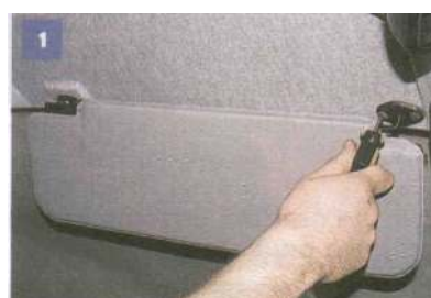
Śrubokrętem krzyżowym odkręcamy dwa wkręty samonacinające mocowania osłony.
