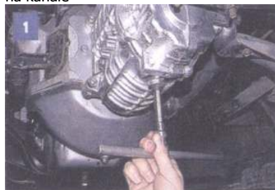
Kluczem sześciokątnym 12 odkręcamy korek spustowy ...
