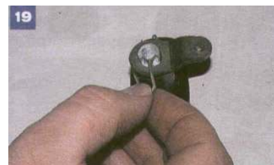
19 Ogniwo przegubowe (zabierak) montuje się na blokadzie zamka tylko w określonym położeniu.
