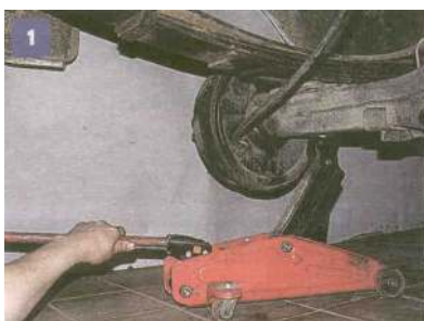
Podnośnikiem podnosimy jedną stronę tylnego mostu.
