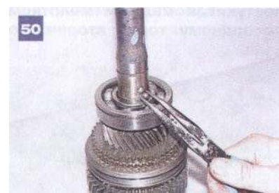
... i wyjmujemy kulkę ustalającą go.
