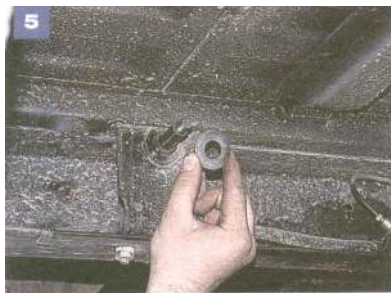
Na szpilce górnego mocowania amortyzatora zamontowana jest jeszcze jedna podkładka.
