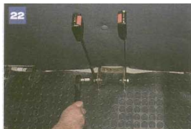
Tym samym narzędziem odkręcamy śrubę i zdejmujemy zaczep pasa biodrowego.
