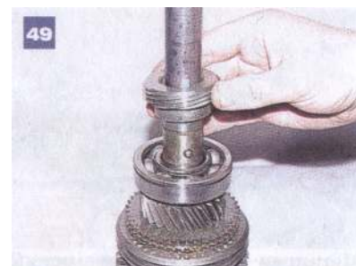
Zdejmujemy koło zębate napędu prędkościomierza...
