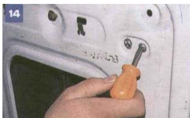
14 Śrubokrętem odkręcamy dwa wkręty mocujące wspornik układu cięgowego zamka.
