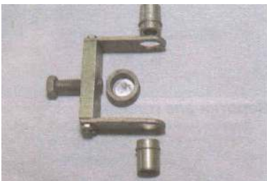
Ściągacz przegubu kardana.
