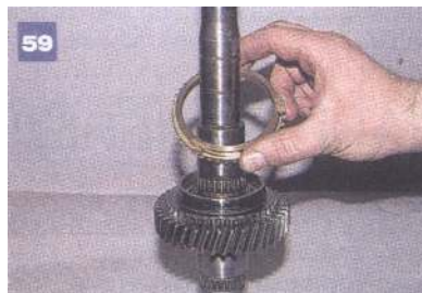
Ściągamy pierścień synchronizatora.
