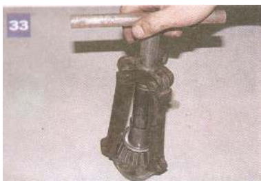
Wytłaczamy z końcówki koła zębatego wewnętrzny pierścień łożyska tylnego.
