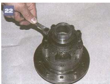
22 Kluczem 13 odkręcamy osiem śrub łączących części obudowy mechanizmu różnicowego.
