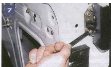
7 Kluczem 10 odkręcamy dwie śruby mocowania kłamki drzwi.
