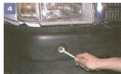
Kluczem zwykłym lub nasadowym nr 12 odkręcamy trzy śruby mocujące zderzak. Pod śrubami znajdują się podkładki specjalne.
