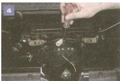
Kluczem zwykłym lub nasadowym 7 odkręcamy dwie nakrętki mocowania przewodów i odłączamy je od wyjść rezystora silnika elektrycznego.
