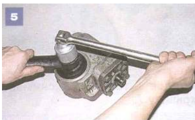
Kluczem nasadowym 36 odkręcamy i zdejmujemy nakrętkę mocowania ramienia ...
