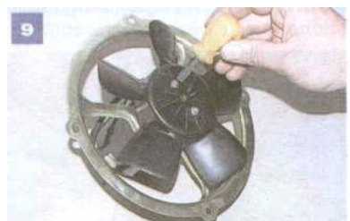
Śrubokrętem odkręcamy dwa wkręty ...
