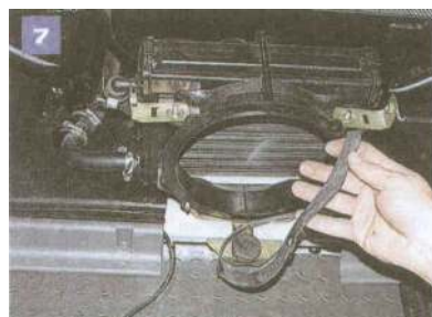
Pomiędzy kołpakiem a obudową nagrzewnicy założony jest gumowy pierścień uszczelniający.
