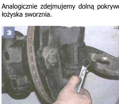
Kluczem zwykłym lub nasadowym 17 odkręcamy nakrętkę blokady sworznia.
