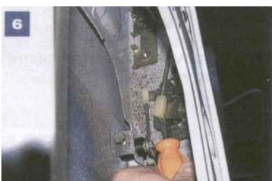
6 Śrubokrętem odłączamy od zamka ciągną zewnętrzną kłamki drzwi.
