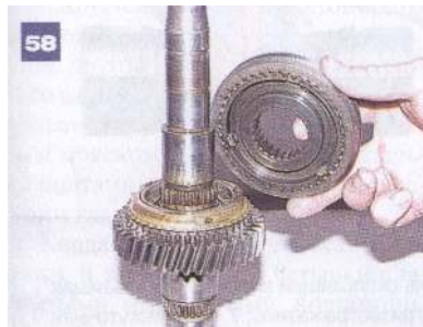
... sprzęgło włączania V biegu i biegu wstecznego.
