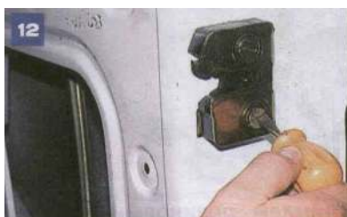
12 Śrubokrętem odkręcamy dwa wkręty mocujące mechanizm ryglowy zamka ...
