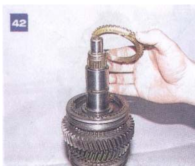
Zdejmujemy pierścień synchronizatora II biegu.
