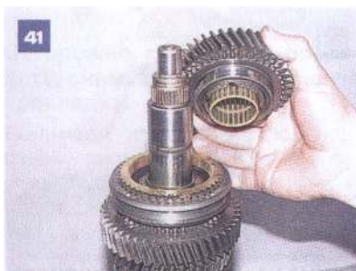
Zdejmujemy koło zębate II biegu wraz z łożyskiem.
