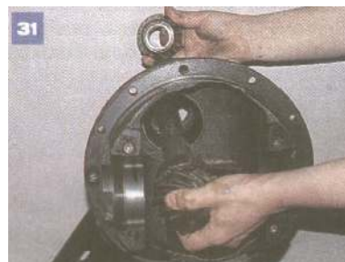
31 Wyjmujemy z obudowy reduktora napędzające koło zębate (można go wybić uderzeniami młotka w koniec wału przez podkładkę z miękkiego metalu) i pierścień wewnętrzny łożyska przedniego.
