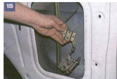
15 Wyjmujemy układ dźwigniowy zamka razem ze wspornikiem i ciągnami.
