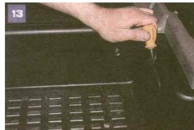
Śrubokrętem podważamy i zdejmujemy luk w obiciu stopnia nadwozia.
