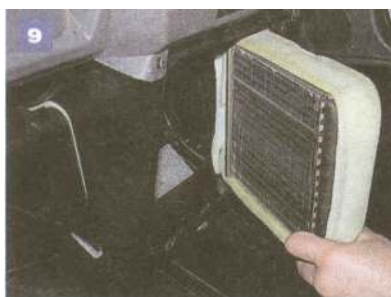
Wyjmujemy z nagrzewnicy radiator.
