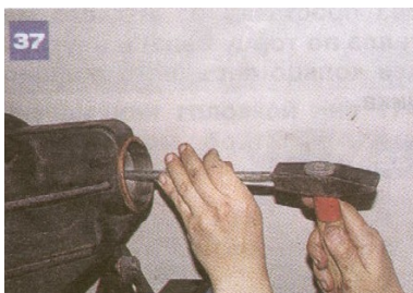
Analogicznie wybijamy zewnętrzny pierścień łożyska tylnego.
