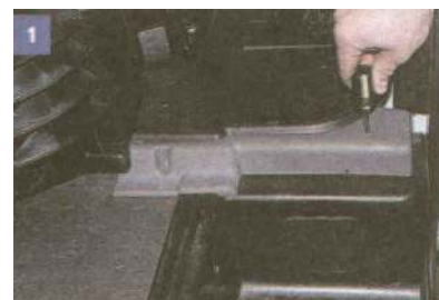
Śrubokrętem krzyżowym odkręcamy dwa wkręty samonacinające ...
