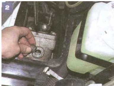
... do dolnej krawędzi otworu wlewowego. Wkręcamy korek na miejsce.
