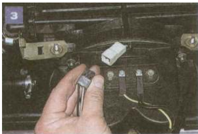
Odlączamy wtyczkę od silnika elektrycznego nagrzewnicy.
