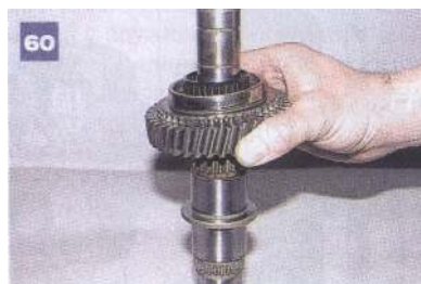
Zdejmujemy koło zębate biegu wstecznego wraz z łożyskiem.
