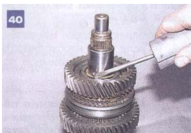
Namagnesowanym śrubokrętem wyjmujemy kulkę ustalającą półpierścień.
