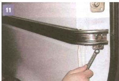
Kluczem 12 odkręcamy śrubę zewnętrznego mocowania prowadnicy.
