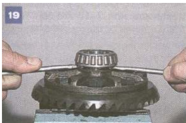
19 W powstały luz wstawiamy dwa mocne śrubokręty (lub łyżki do montażu opon) i ściągamy...
