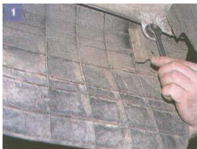
Kluczem 13 odkręcamy nakrętkę bocznego mocowania zderzaka ...
