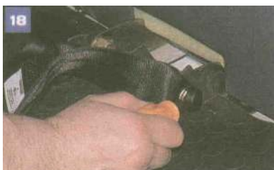
Zdejmujemy nakładkę ozdobną łba śruby mocowania zaczepu pasa.
