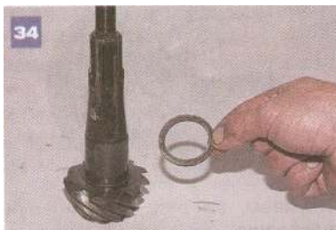
Zdejmujemy podkładkę regulacyjną napędzającego koła zębatego.
