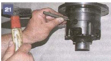
21 Przecinakiem zaznaczamy wzajemne położenie obudowy mechanizmu różnicowego i osi satelitów.
