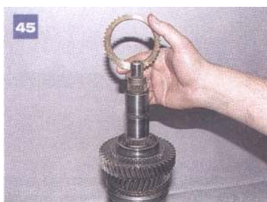
... i pierścień synchronizatora I biegu.
