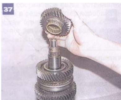
... i koło zębate trzeciego biegu razem z separatorem z tworzywa sztucznego i wałeczkami.
