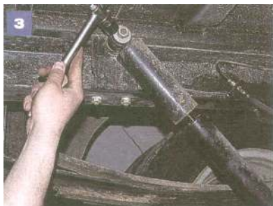
Analogicznie postępujemy z górnym mocowaniem amortyzatora.
