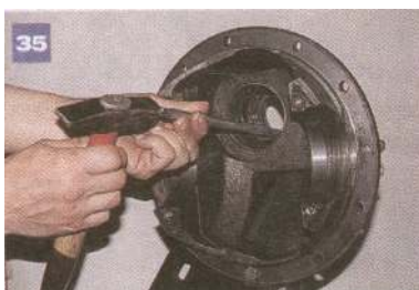
Wybijakiem wybijamy zewnętrzny pierścień łożyska przedniego ...
