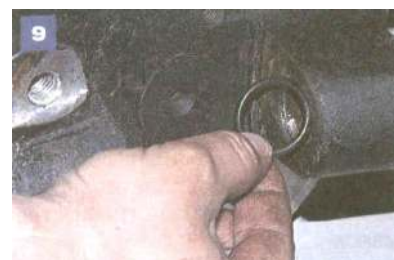
Wyjmujemy gumowy pierścień uszczelniający z górnego ucha zwrotnicy.
