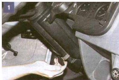
Podnosimy dźwignię blokady kolumny kierownicy.
