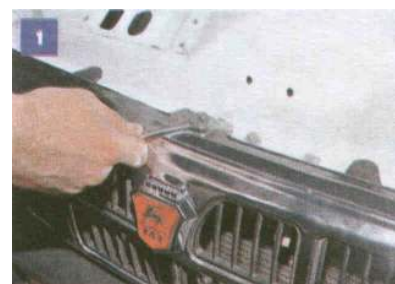
Kluczem 10 odkręcamy trzy śruby górnego ...
