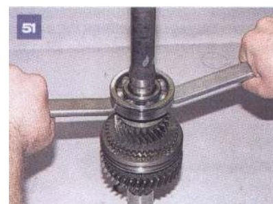
Dwoma łyżkami montażowymi lub specjalnym ściągaczem, ściągamy łożysko tylne wału głównego.
