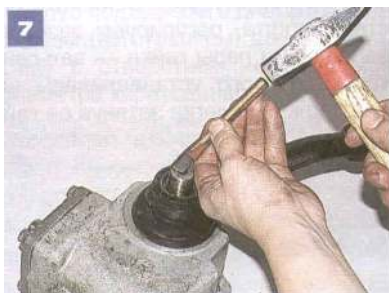
Zaznaczamy przecinakiem położenie ramienia na wale i polewamy połączenie cieczą penetrującą (naftą, WD-40, itp.)
