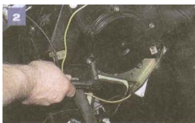
Kluczem 10 odkręcamy trzy nakrętki i śrubę mocującą pokrywę wentylatora.
