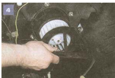
Wyjmujemy silnik elektryczny z wentylatora.
