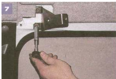
Tym samym kluczem odkręcamy dwie śruby mocujące podparcie prowadnicy górnej do nadwozia.
