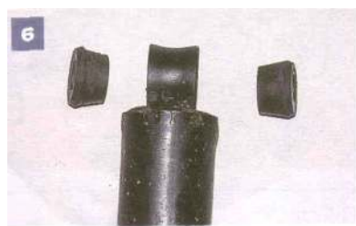
Wyjmujemy z ucha amortyzatora tulejki gumowe.
