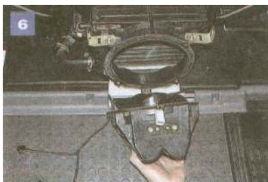
... i zdejmujemy kołpak razem z silnikiem elektrycznym.
