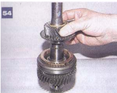
Zdejmujemy koło zębate V biegu wraz z łożyskami ...
