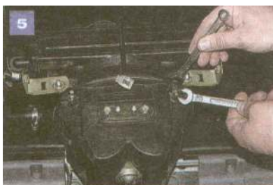
Przytrzymując kluczem 10 śruby mocujące kołpak silnika elektrycznego przed przekręcaniem, takim samym kluczem odkręcamy cztery nakrętki ...
