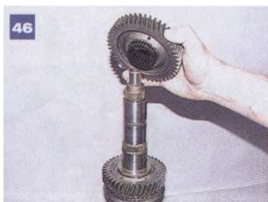
Zdejmujemy koło zębate I biegu wraz z łożyskiem.
