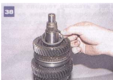
Śrubokrętem podważamy i zdejmujemy pierścień oporowy ...
