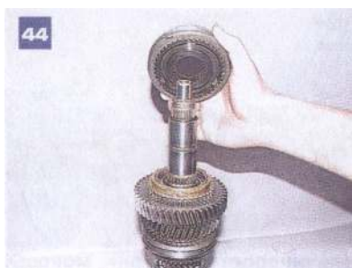
Zdejmujemy sprzęgło włączania I i II biegu...
