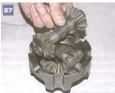
27 Wyjmujemy osie wraz z satelitami i ich podkładkami.
