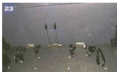
Pasy zakładamy w odwrotnej kolejności do demontażu na ich poprzednie miejsca mocowania.
