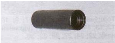
Oprawka do instalowania koszulek zgarniaków oleju.
