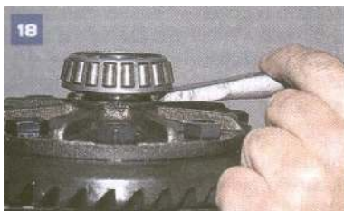
18 Uderzając w przecinak, unosimy wewnętrzny pierścień łożyska.
