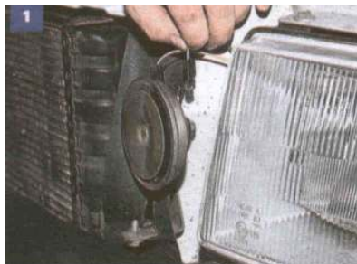
Odcinamy dwie końcówki przewodów od wyjść sygnału dźwiękowego.
