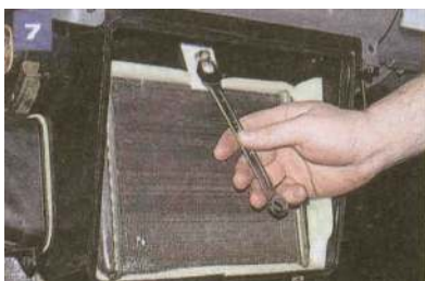
Kluczem 13 odkręcamy nakrętkę mocowania radiatora ...
