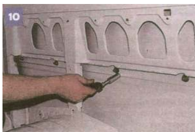
Kluczem nasadowym 13 odkręcamy cztery nakrętki szpilek mocowania prowadnicy środkowej.
