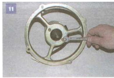
Kluczem 8 odkręcamy dwie nakrętki mocowania ...
