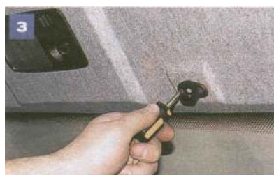
Tym samym śrubokrętem odkręcamy wkręty samonacinające mocowania zaczepu ...
