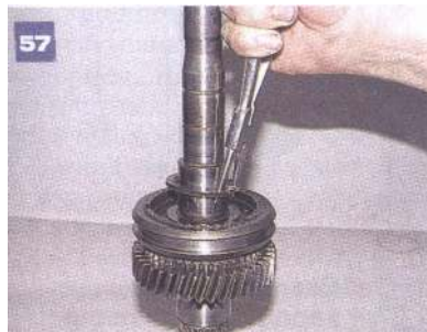
Specjalnymi szczypcami i śrubokrętem ściągamy pierścienie sprężyste, a następnie ...
