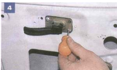
4 Śrubokrętem odkręcamy dwa wkręty mocowania wewnętrznej kłamki drzwi.
