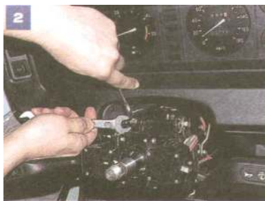
Dwoma kluczami 13 luzujemy przeciwnakrętkę i dociągamy nakrętkę śruby mocowania dźwigni blokady.
