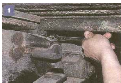
Kluczem 13 odkręcamy nakrętkę mocowania poduszki resoru.
