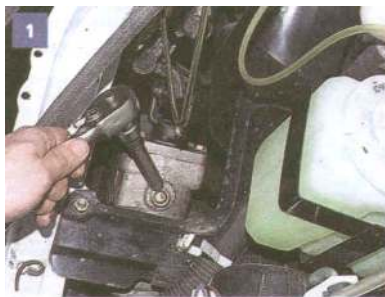
Kluczem sześciokątnym gniazdowym 12 odkręcamy korek.
