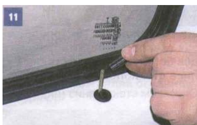
11 Ręką odkręcamy przycisk blokady.
