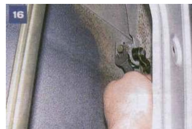
16 Kluczem 10 odkręcamy na 2 - 3 obroty śrubę mocującą blokadę zamka.
