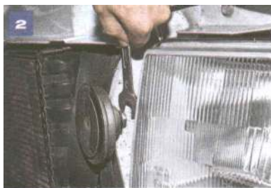
Kluczem 13 odkręcamy nakrętkę mocowania sygnału dźwiękowego do wspornika.
