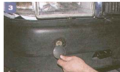
Podważając śrubokrętem, zdejmujemy ze zderzaka dwie zaślepki z tworzywa.
