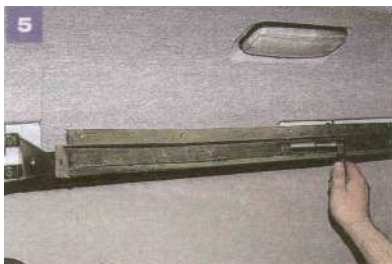
Kluczem nasadowym 10 odkręcamy cztery śruby mocujące prowadnicę górną.
