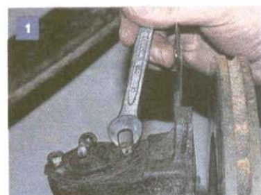
Kluczem 10 odkręcamy dwie śruby mocujące ...
