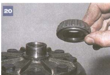
20 ... wewnętrzny pierścień łożyska razem z separatorem i rolkami.
