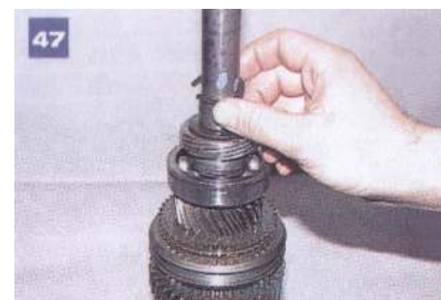
Podważając cienkim śrubokrętem, ściągamy pierścień oporowy...
