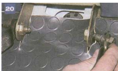
... i zdejmujemy zaczep pasa bezpieczeństwa prawego tylnego siedzenia pasażera.
