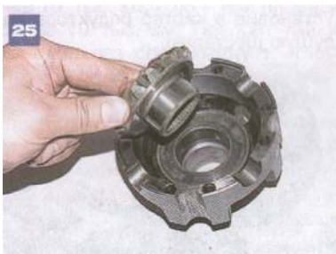
25 Ze zdjętej połówki obudowy wyjmujemy koło zębate półosi ...
